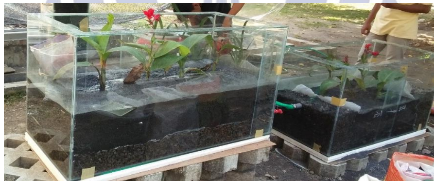
Gambar 2. Realisasi unit treatment gabungan VSSF CW dan HSSF CW dengan C.indica
