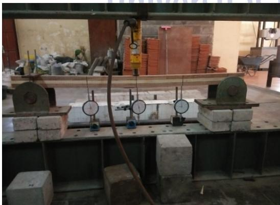
**Gambar 6.** Foto Pengujian Lentur Balok Laminasi
