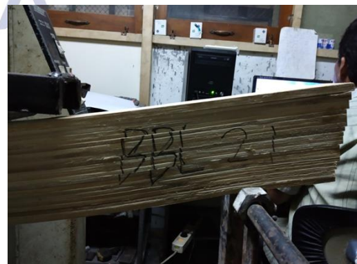
Gambar 5. Kerusakan perekat pada balok bambu petung laminasi
