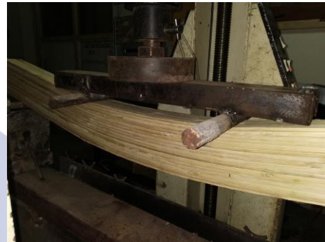
Gambar 4. Pola kerusakan pada titik pembebanan balok
