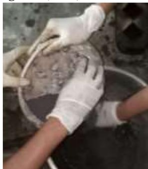
Gambar 8. Proses pembuatan mortar dengan APD
