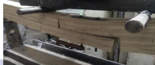
Gambar 7. Pola kerusakan pada titik pembebanan balok
