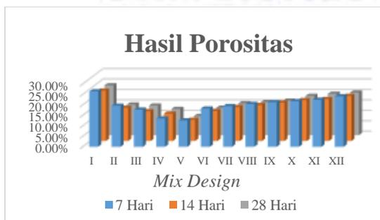
**Gambar 3.** Grafik Hasil Pengujian Porositas
