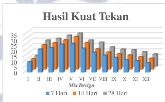
**Gambar 2.** Grafik Hasil Pengujian Kuat Tekan Mortar Geopolimer 12M
