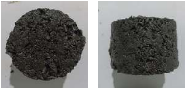
Gambar 11. Benda uji setelah pengujian stabilitas waktu perendaman ½ jam
