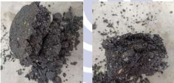
Gambar 12. Benda uji setelah pengujian stabilitas waktu perendaman 24 jam
