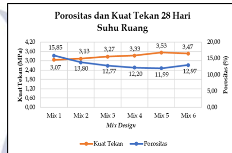
Gambar 3. Grafik Hubungan Porositas dan Kuat Tekan Benda Uji – Suhu Ruang
