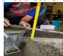
Gambar 3. 3 Pengujian Slump pada Beton
