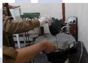
Gambar 2. Proses pencampuran agregat dengan aspal
