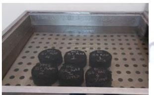
Gambar 5. Perendaman benda uji pada *water bath*
