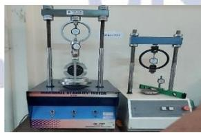
Gambar 6. Pengujian dengan alat marshall
