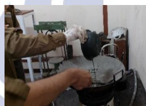
Gambar 2. Proses pencampuran agregat dengan aspal
