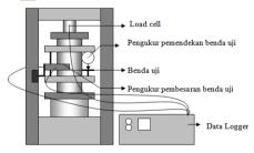
**Gambar 2.** Pengujian modulus elastisitas beton Selanjutnya nilai modulus elastisitas dihitung dengan rumus persamaan sebagai berikut:
