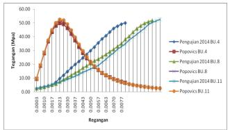
Gambar7. Tegangan Regangan Beton K500 dengan Metode Popovics
