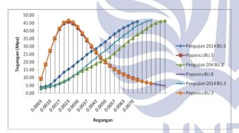
Gambar 6. Tegangan Regangan Beton K450 dengan Metode Popovics
