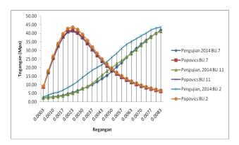
Gambar 5. Tegangan Regangan Beton K400 dengan Metode Popovics
