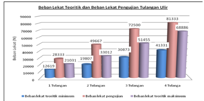
Grafik 4.6 Perbandingan nilai beban lekat rata-rata tulangan terkumpul saat pengujian dengan beban lekat teoritik
