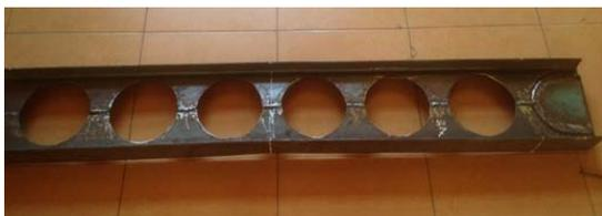
Gambar 11. Benda uji 7 (D=180mm) tidak terjadi patahan
