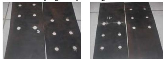
Gambar 11 Kerusakan Lubang Baut Jarak 40 mm dan 35 mm
