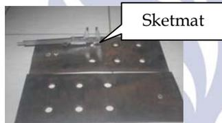
Gambar 14 Pengukuran Lubang Baut
