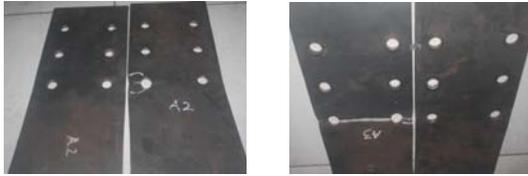
Gambar 12 Kerusakan Lubang Baut Jarak 30 mm dan 25 mm
