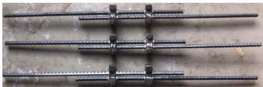
Gambar 5. Benda uji BUM-1 (Sambungan mekanis dengan panjang lewatan 26 db)
