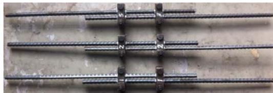
Gambar 6. Benda uji BUM-2 (Sambungan mekanis dengan panjang lewatan 21 db)
