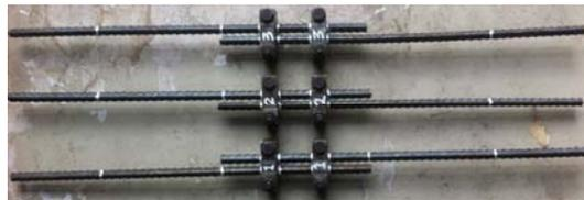
Gambar 7. Benda uji BUM-3 (Sambungan mekanis dengan panjang lewatan 16 db)
