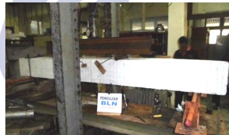
Gambar 9.. Pengujian Balok Lentur Tanpa Lubang (BLN)
