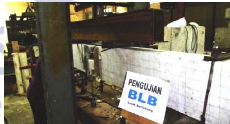
Gambar 10. Pengujian Balok Lentur Berlubang (BLB)
