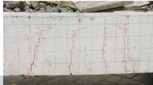
Gambar 9 Pola Retak BL.0% Sisi Barat
