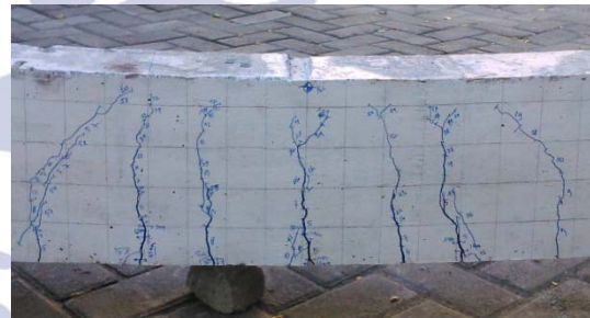
Gambar 11 Pola Retak BL.1% Sisi Barat
