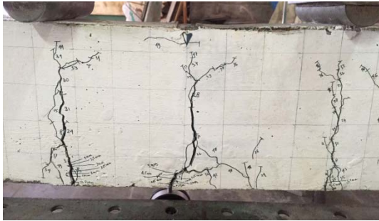
Gambar 13 Pola Retak BL.3% Sisi Barat
