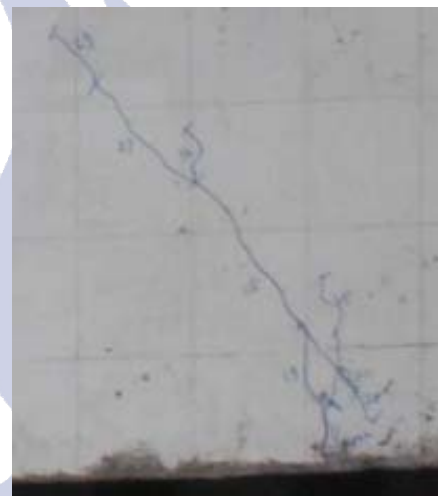
Gambar 15: Retak Pertama Geser BG.0% Sumber: Hasil Eksperimen
