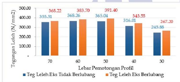
Gambar 6. Grafik perbandingan tegangan leleh eksperimen bagian tidak berlubang dan berlubang *castellated beam*
