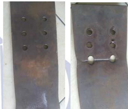
Gambar 10 Kerusakan Lubang Baut Jarak 50 mm, 65 mm, 60 mm, 45 mm dan 35 mm
