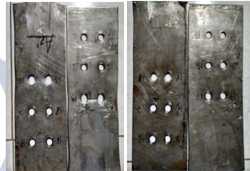
Gambar 12 Kerusakan Lubang Baut Jarak 50 mm dan 55 mm
