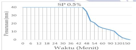
Gambar 5 pengujian *vicat* menggunakan *Superplasticizer* 0.5%
