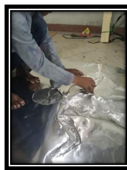
Proses penekanan dari bagian negative logam membentuk bidang cekung. Gambar 4.3.5 ( Dokumentasi, Emil fais 2019 )
