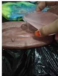
**Gambar 4.** Proses Teknik penuangan bahan resin ke dalam cetakan lilin
