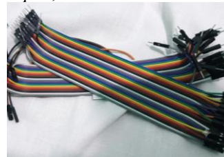
Gambar 19. Kabel Jumper (Dok. Laila Azzahra Sudjatkiko, 2026)
