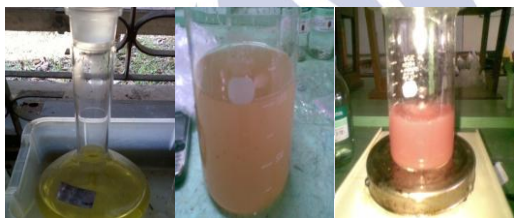
Gambar 1. (a). larutan induk \text{HAuCl}_4 1000 ppm, (b). setelah penambahan natrium sitrat, (c). larutan nanopartikel emas
