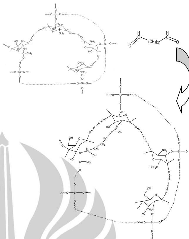
Gambar 2. Reaksi hipotetik antara kitosan-silika bead dengan glutaraldehid [10].
