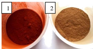
Gambar 3. Bentonit Terpilang  $\text{Fe}_2\text{O}_3$  (1) dan Bentonit (2)
