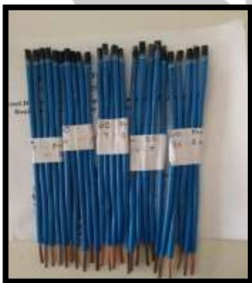
Gambar 1. Elektroda GO-parafin
