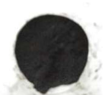
**Gambar 1.** Karbon Aktif ukuran 100 mesh yang telah dipanaskan pada suhu 100 °C
