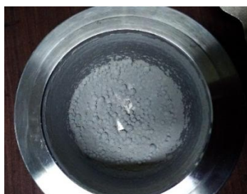
Gambar 2. Hasil sintesis nanozeolit menggunakan planetary ball milling
