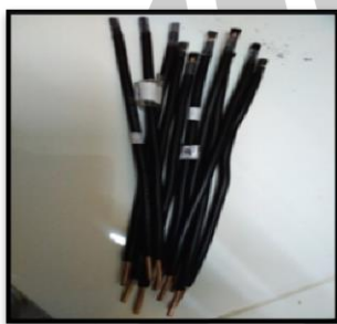
Gambar 1. Elektroda Graphene oxide :parafin dengan 4 macam variasi
