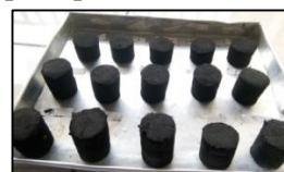
Gambar 1. Briket campuran arang kulit durian dan tempurung keluwak
