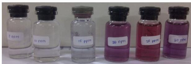
Gambar 3. Koloid nanopartikel emas dengan berbagai berbagai konsentrasi larutan HAuCl<sub>4</sub>
