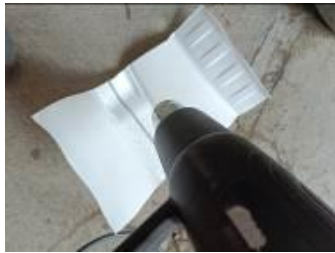
Gambar 9. Proses pemotongan botol dilanjutkan pemanasan bentuk botol hingga menjadi pipih (Sumber: Dokumentasi Galang Marcellino W.2023)
