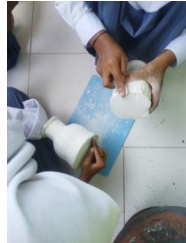
Gambar 12. Setelah dijemmur dan kering amplas bagian luar kerajinan dengan amplas hingga dirasa halus Pengamplasan kerajinan dengan amlas oleh siswa kelas X DKV (Dok: Novita Sari. 2022)
