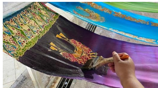
Gambar 14. Tahap penguncian warna (Sumber: Dokumentasi Della Syadhira, 2025)
