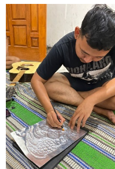
Gambar 12. Pencembungan pada logam Sumber: Narendra, 2026
