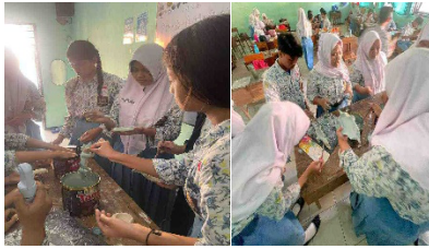
Gambar 3. Proses Pencelupan Glasir Sumber: Dokumentasi Yunita, 2026
