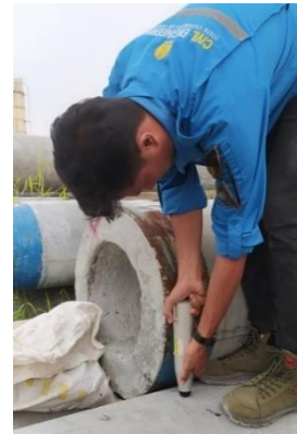
Gambar 6. Proses Pengujian Palu Beton ( Schmidt Hammer Test ) Pada Spun Pile
