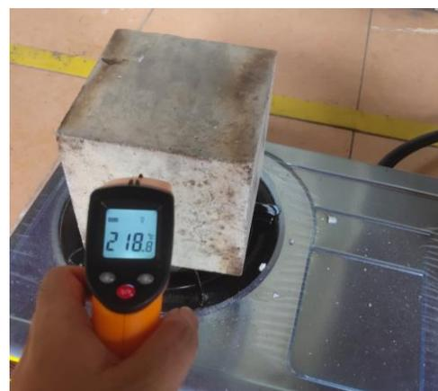
Gambar 2. Pembakaran beton dengan api
