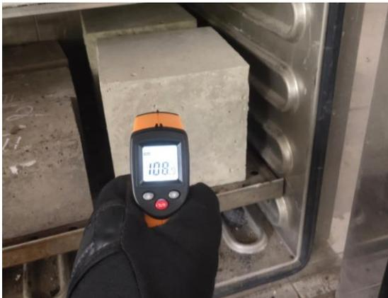
Gambar 6. Penambahan suhu beton dengan cara dioven
