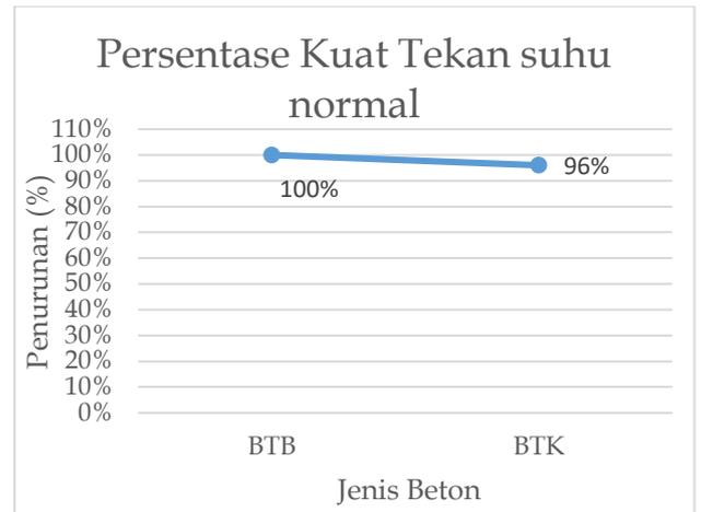
Gambar 4. Hasil Pengujian benda uji beton tanpa bahan campuran dan beton dengan bahan campuran agregat kaca
