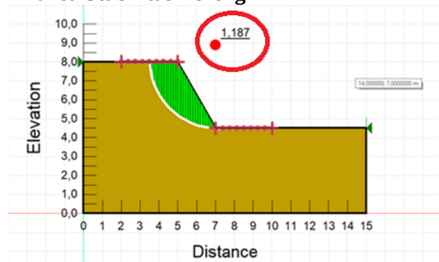
Gambar 7. Hasil analisa stabilitas lereng
