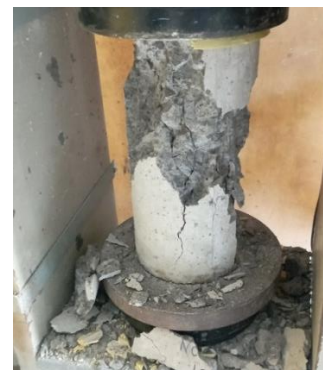
Gambar 12. Kerusakan Akibat Uji Kuat Tekan Beton Normal
