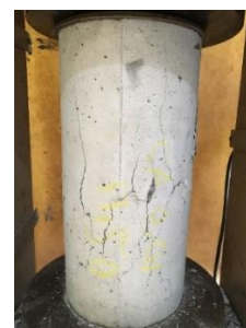
Gambar 13. Kerusakan Akibat Uji Kuat Tekan Beton Dengan Bahan Tamba AEA
