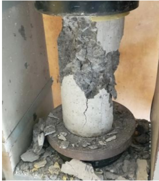
Gambar 12. Kerusakan Akibat Uji Kuat Tekan Beton Normal
