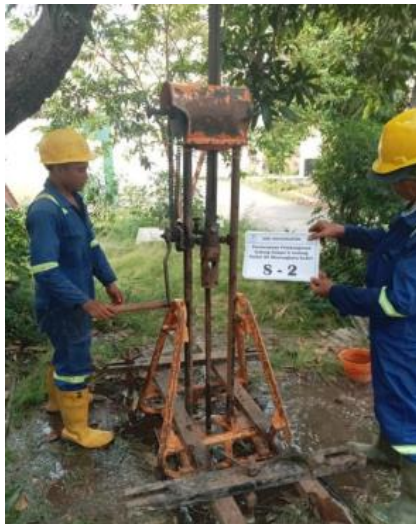
Gambar 5. Dokumentasi Uji Sondir Titik 2
