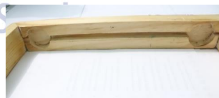
Gambar 5. Lubang Bagian Dalam Balok Kayu
