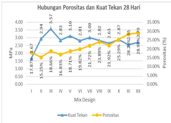
**Gambar 2. Grafik Hubungan Porositas dan Kuat Tekan Benda Uji**
